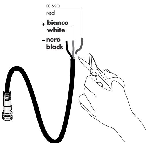
**tagliare e isolare adeguatamente il cavo elettrico di colore rosso**
